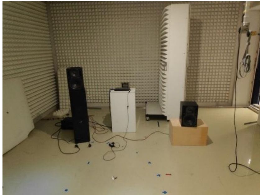
6. ábra: Mérési elrendezés félsüketszobában
