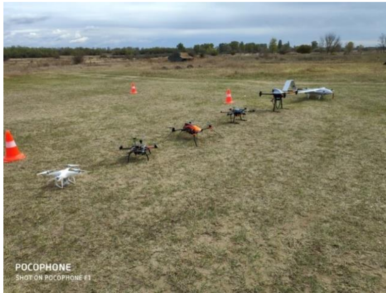
8. ábra: Az ócsai mérésen reptetett drónok, balról jobbra: DJI Phantom4, Quad480, Eurotor4, Tarot680, Secopx8, és Flying Ranger
