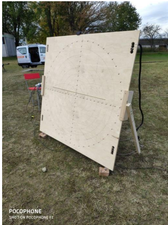
9. ábra: Mérési elrendezés: a mérésekhez felhasznált 48 csatornás mikrofontömb, az állvány tetejére erősített webkamerával
